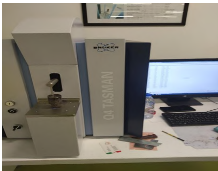
1-расм. Спектрометр “Q4 TASMAN Bruker” қурилмаси ва қурилма ёрдамида тайёр намуналарнинг химиявий хоссаларини ўрганиш жараёни
