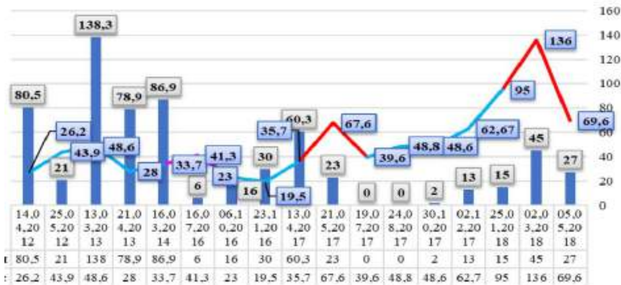
1-rasm. G'ujumsoy konining yer osti konlarida suv iste'molining atmosfera yog'inlari bilan o'zgarishining qiyosiy grafigi
